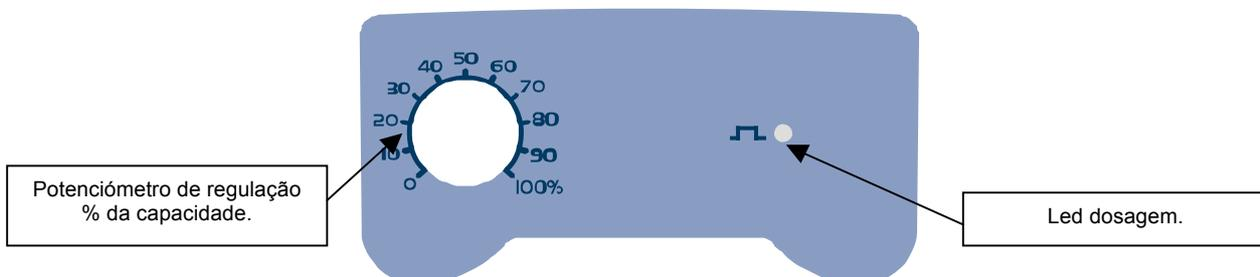
A bomba doseia manualmente à percentagem seleccionada com o potenciômetro.
