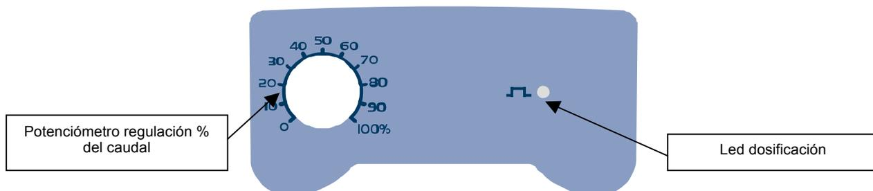
La bomba dosifica el porcentaje seleccionado de forma manual con el potenciómetro.
