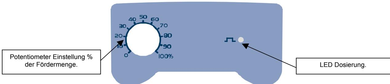
Die Pumpe dosiert manuell den mit dem Potentiometer gewählten Prozentsatz
