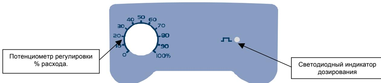
Насос выполняет дозирование вручную, согласно проценту, установленному с помощью потенциометра.
